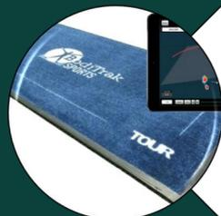
**Boditrak:** Pressure plate per l'analisi delle interazioni tra giocatore e terreno. Permette di ottimizzare lo spostamento del peso durante lo swing per imprimere maggior velocità alla palla.
