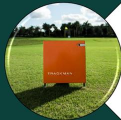
**Trackman 4:** Radar doppler per l'analisi del volo della palla e delle performance del bastone. Utile per fare diagnosi delle caratteristiche di swing, per il putting outdoor e per il club fitting.
